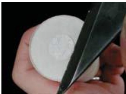
Remova o “botão” do revestimento criado pelo nivelamento
